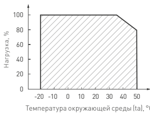
Рис. 2. Максимальная допустимая нагрузка, % от мощности источника.
